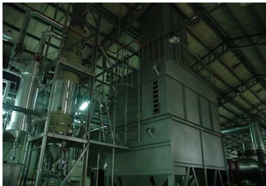
圖 2 流體化浮動床溶劑回收設備及回收含 Toluene、MEK 有機溶劑相片
