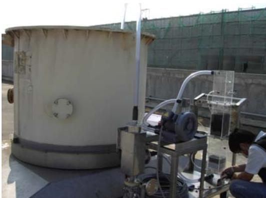
圖 7 除酸濾材實廠測試示意圖
