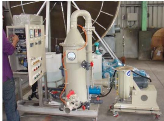
圖 8 專利設計除酸濾材線上再生系統示意圖
